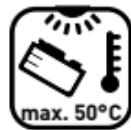
Az akkumulátor csak a -10 °C és +50 °C közötti hőmérséklet-tartományok között használható és tárolható.
